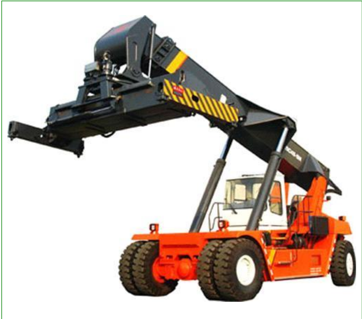
Bild 21: Reachstacker für Containertransportprozesse
