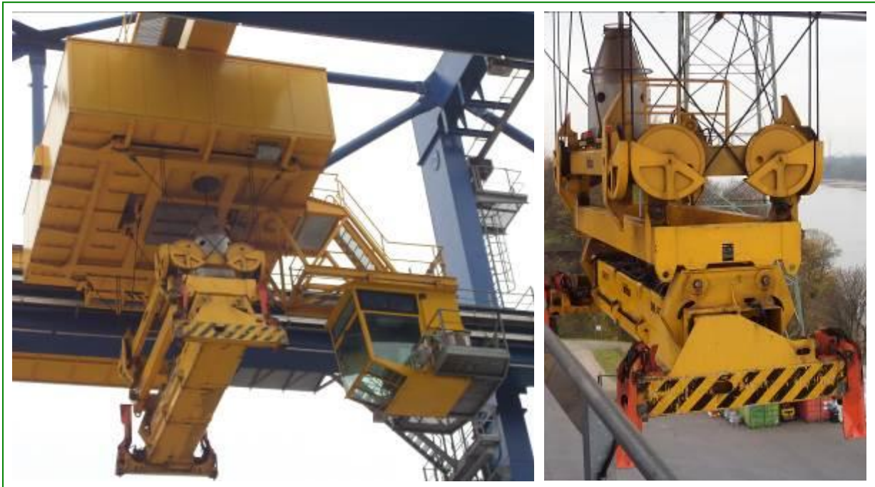
Bild 20: Spreader zur Aufnahme von 20` bis 45`-Containern, Wechsel- u. Jumbobehältern
